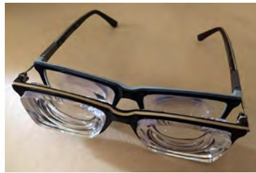
Instrumento óptico em formato de óculos que amplia o campo visual de portadores de visão tubular
